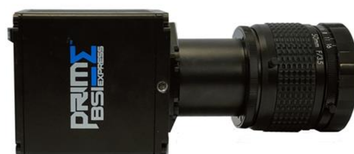
Рис. 2. Сенсор, включающий камеру УФ-А диапазона, объектив и сменные фильтры.
